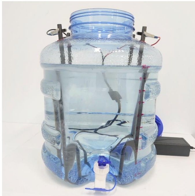
ภาพที่ 3.2 ปฏิกิริยาเคมีที่บริเวณแท่งแกรไฟต์เกิดฟองแก๊ส : \text{H}_2(\text{g}) , \text{O}_2(\text{g}) และ \text{Cl}_2(\text{g}) และเกิดสารละลายกรดไฮโปคลอรัสที่ต้องการ
