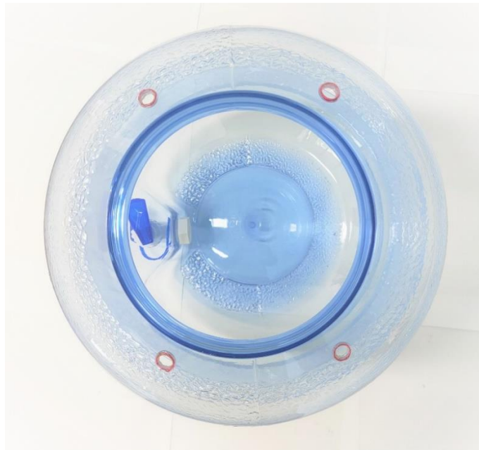
ภาพที่ 2.4 การเจาะช่องสำหรับใส่แท่งแกรไฟต์ (ขั้วอิเล็กโทรด)
