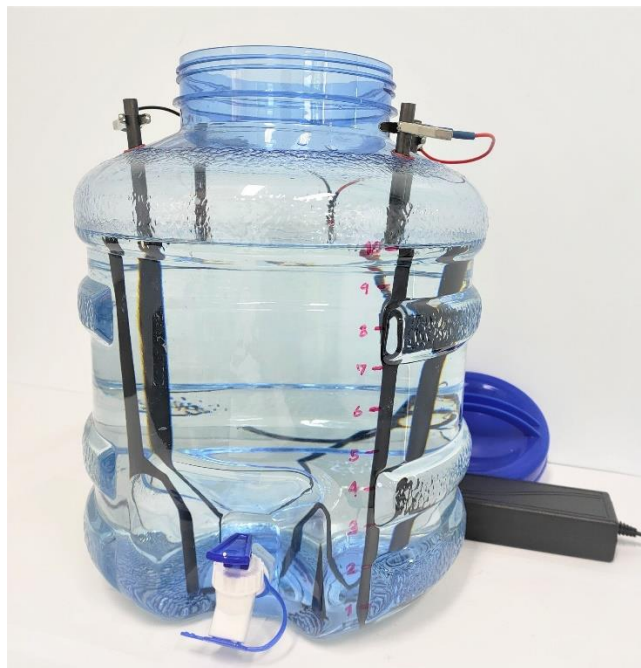
ภาพที่ 3.1 ชุดอุปกรณ์เครื่องผลิตที่มีสารละลายเกลือแกงและน้ำส้มสายชูพร้อมสำหรับใช้งาน
