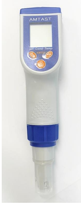
ก) เครื่องพีเอชมิเตอร์แบบปากกา/ เครื่องโออาร์พีมิเตอร์แบบปากกา
