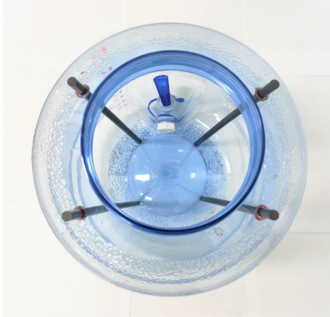
ภาพที่ 2.5 การตรวจสอบขนาดของช่องสำหรับใส่แท่งแกรไฟต์เพื่อป้องกันการลัดวงจรไฟฟ้า
